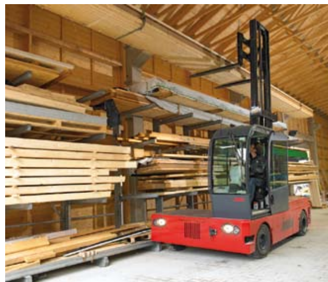
Wózki boczne są wykorzystywane do transportu długich elementów – od 3 do 20 m.
