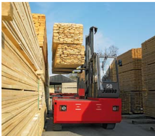
Transport długich elementów przy pomocy wózka bocznego gwarantuje zachowanie minimalnego korytarza pracy tj. 2400 mm, gdzie dla wózka wielokierunkowego wynosi 2650 mm.
